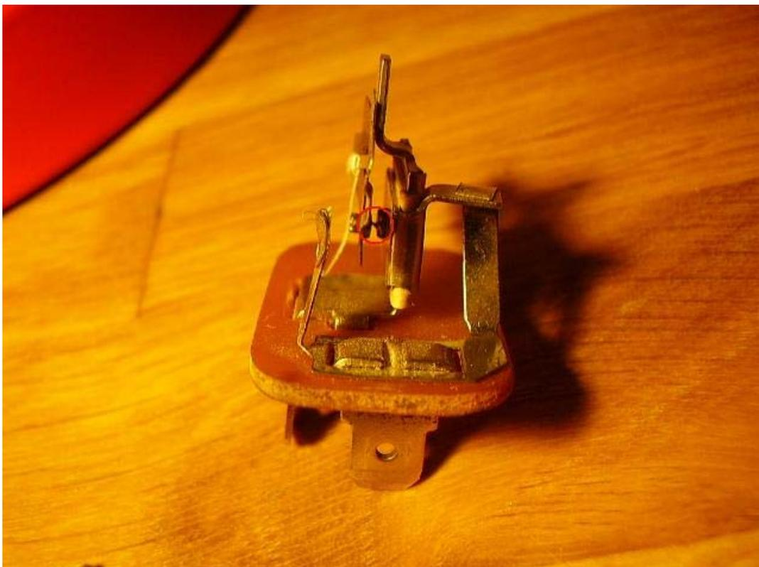
Se cría una especie de roñilla que impide que la zona de contacto donde se abre y cierra el circuito funcione correctamente.
