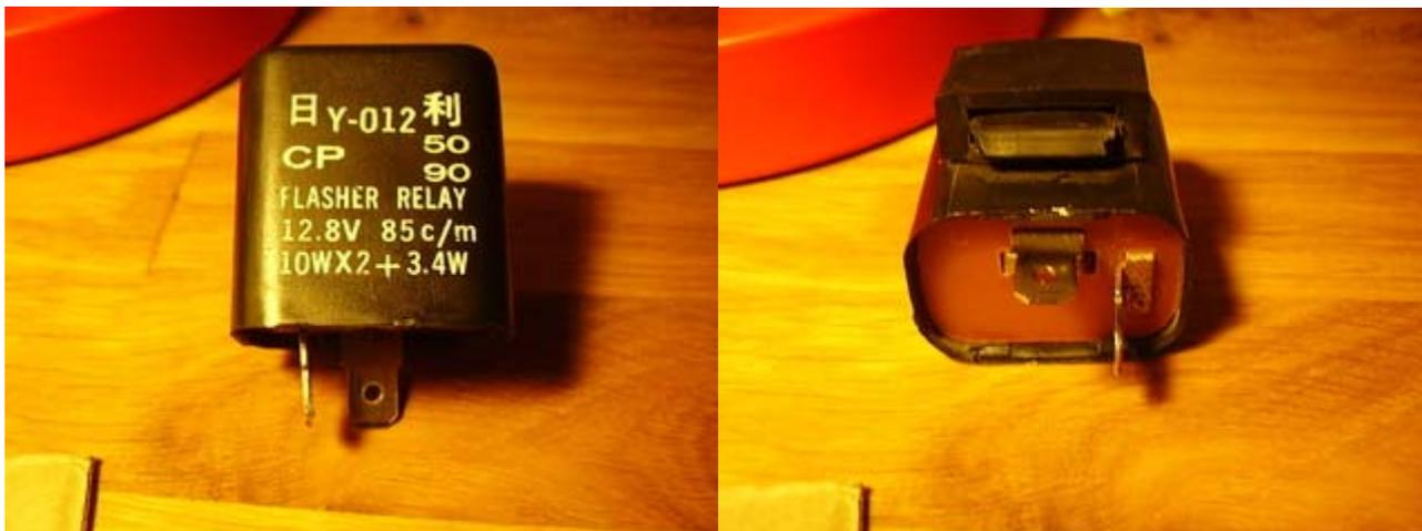
Parece que se trata de un material bimetálico que se dilata por el paso de la corriente y abre el circuito, para luego volverse a enfriar y cerrarlo.
